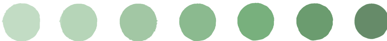
Рис. 2.1 Тест-шкала для визначення фосфат-іонів у вигляді іонного асоціату барвника малахітового зеленого з \text{PMo}_{12}\text{O}_{40}^{3-}
